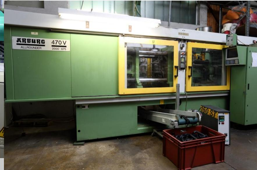
Die Zuhaltkraft unserer 20 Spritzmaschinen liegt zwischen 15 - 200 Tonnen. Daher können wir Kleinstteile von weniger als 1g bis 380g herstellen.
